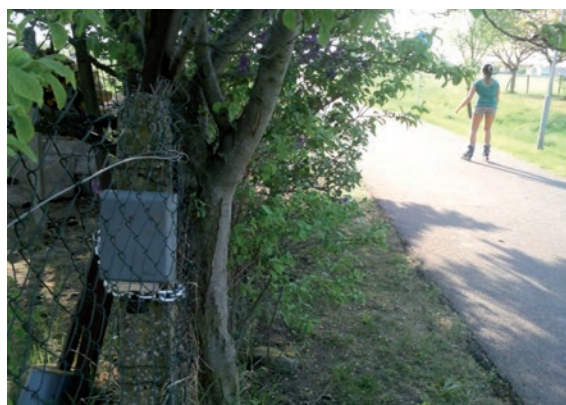
Rys. 40. Automatyczny licznik z czujnikiem ciepła (Region Morawy Południowe)
