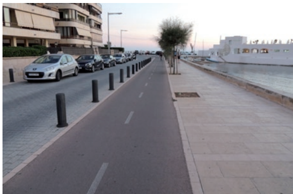
Rys. 37. Rozdzielenie ruchu zmotoryzowanego i niezmotoryzowanego za pomocą słupków (Mallorca).
