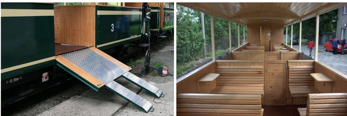
Von links: Kipprampe und das Innere des Wagens zur Beförderung von nicht mobilen Personen
